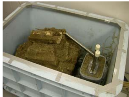
廣瀬産業（株）website から。シロアリの巣に餌木を乗せ右側に水取装置を設置する
